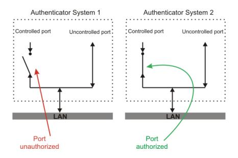
في هذا النظام سيكون هناك اتصال فيزيائي بين Supplicant و Supplicant و رغم هذا فلن يتم السماح بارسال في هذا النظام سيكون هناك اتصال فيزيائي بين Supplicant و للمنات الا بعد أن يتم توثيق الدخول بواسطة Authentication server و لهذا تسمي هذه العملية port"-based authentication لأنها تعتمد بالأساس علي السماح أو حجب ولوج الأجهزة رغم اتصاله فيزيائيا عبر بورت السويتش
