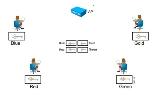
في 802.1X يتم توثيق كل جهاز supplicant بشكل مستقل و تستفيد الشبكات اللا سلكية من ذلك بإضافة دعم RADIUS و إضافي للتشفير بعمل مفتاح فريد WEP key لكل جهاز و لكل عملية اتصال session عبر سيرفر WEP key و في كل مرة يخرج الجهاز ثم يدخل الشبكة اللاسلكية يقوم السيرفر بتكرار هذه العملية و لهذا تطلق علي WEP key اسم session keys
