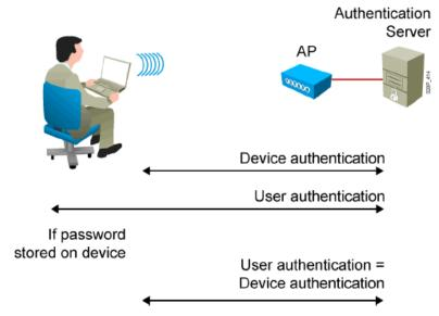
الطرق السابقة تستخدم لتوثيق دخول الأشخاص و لكن ماذا عن توثيق دخول الأجهزة للشبكة و ذلك لضمان عدم دخول لتوثيق الأجهزة طبقا لمواصفات كل جهاز بغض النظر Signature الأجهزة الغير مرغوب فيها للشبكة ، و يتم استخدام عن الشخص الذي يدخل و هذا من عيوبه
