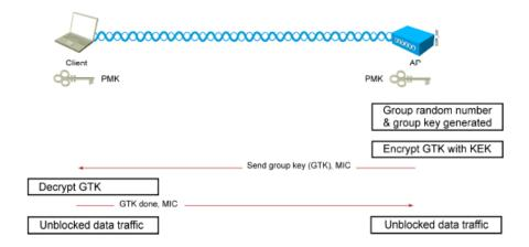
يستخدم ( Groupwise Transient Key لنع الجهاز من استقبال أي رسائل من الأكسس بوينت و يتم ذلك عبر التراسل الثنائي two-way handshake بحذا السيناريو
