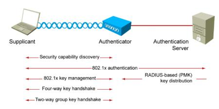
كما هو الحال مع بروتوكلات التوثيق يتم استخدام فريمات التراسل (probe request, probe response) بين الجهاز و الأكسس بوينت الا أن الإختلاف يكمن في أنه لابد أن يتوافق الأكسس بوينت و الجهاز علي هذه العملية أمنيا ثم يستكمل خطوات توثيق 802.1X و عند استكمالها يقوم السيرفر بإرسال master key الأكسس بوينت و التي المختلف مسبقا من الجهاز الطالب للإتصال و لهذا يسمي المفتاح (PMK) و التي يتم منها توليد مفتاح آخر يسمي Pairwise أو التي يتم منها توليد مفتاح آخر يسمي Transient Key (PTK)
